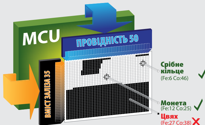
Шкала дискримінації, відображена на дисплеї детектора E-TRAC, що використовує технологію Smartfind
